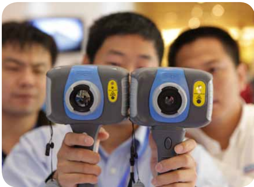
Återförsäljare testar SKF värmekamera TKTI 20 med infraröd detektor vid SKFs konferens för återförsäljare i Beijing, Kina. Värmebilder är en teknik som används i många industrier för tillståndsovervakning.
