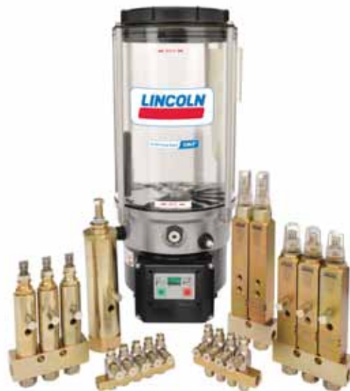
Lincoln-pumpen 653 ingår i det automatiska fettsmörjningssystemet Centro-Matic. Det passar tillämpningar med några få smörjpunkter men även upp till 36 stora injektorer och många fler om mindre injektorer används. Den kan smörja ett lager på upp till 70 meters avstånd och är avsedd både för tunga arbetsfordon och industriella tillämpningar.
