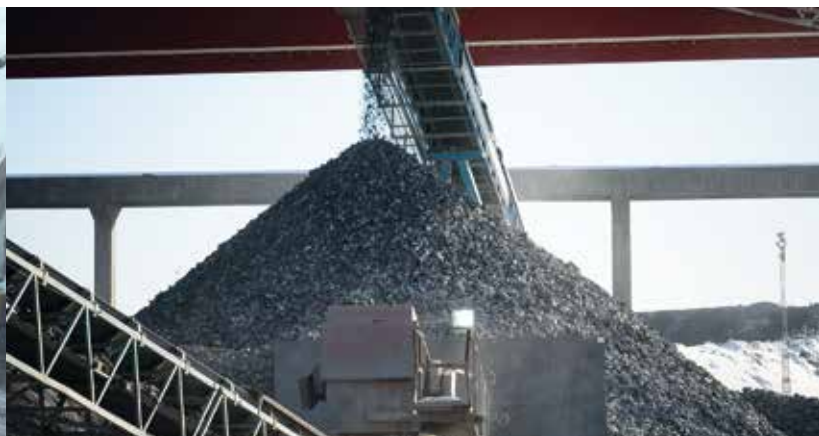
Järnmalmen krossas på industriplanen och fraktas via transportband in i sovringsverket.
