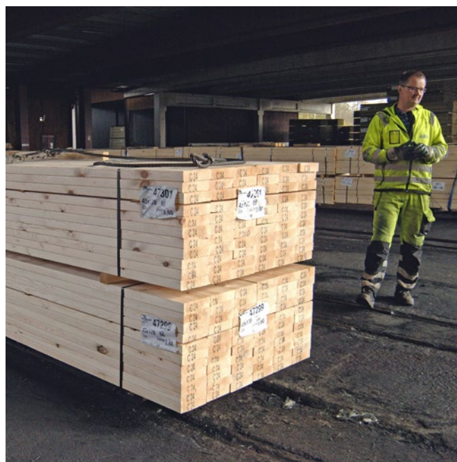
Konstruktionsvirke i gran som ska träskyddsbehandlas för Englandsmarknaden på Bitus i Nybro.
