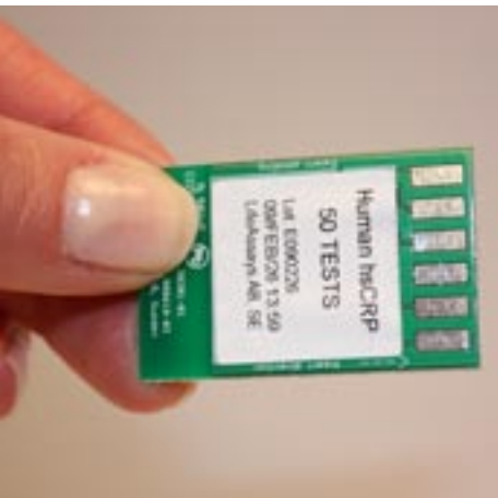
Engångsdatorchip som kvalitetssäkrar och låser instrumentets funktion till testkiten.
