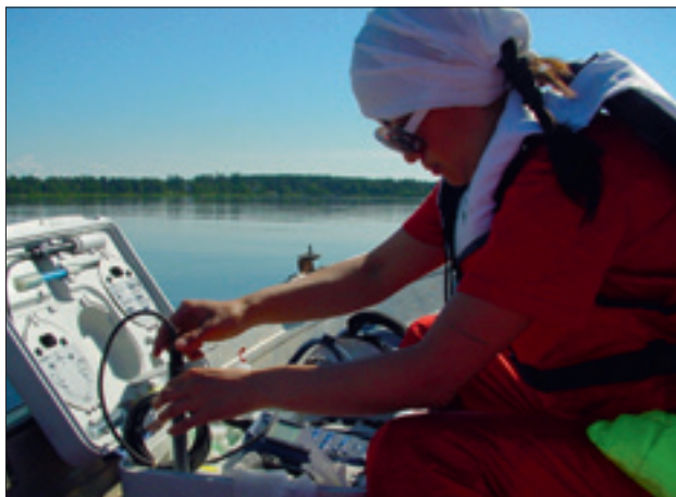
Mätning av pH, konduktivitet och syremättnad i Notviken, Luleå.
